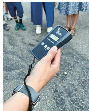
Dank dem Ultraschalldetektor können die Rufe der Fledermäuse hörbar gemacht werden.
